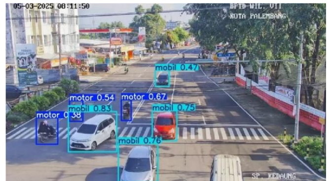
Gambar 2 Contoh hasil deteksi kendaraan menggunakan YOLOv8 pada Simpang Kedaung
